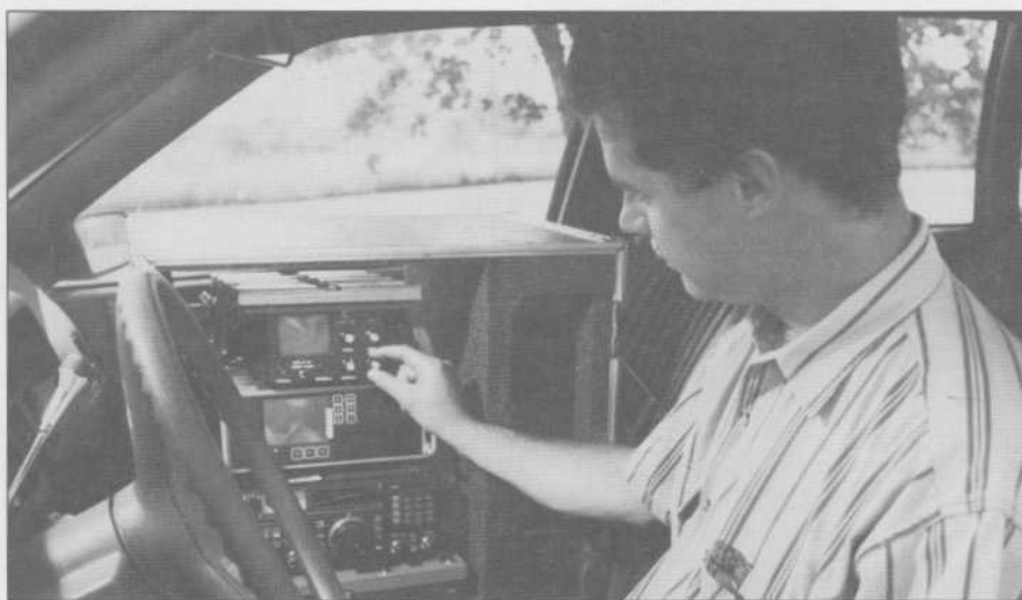
L'inspecteur radio Robert Régimbald règle le système de radiogoniométrie Techcomm, l'un des deux systèmes d'établissement de la direction des signaux que le Ministère évalue.
